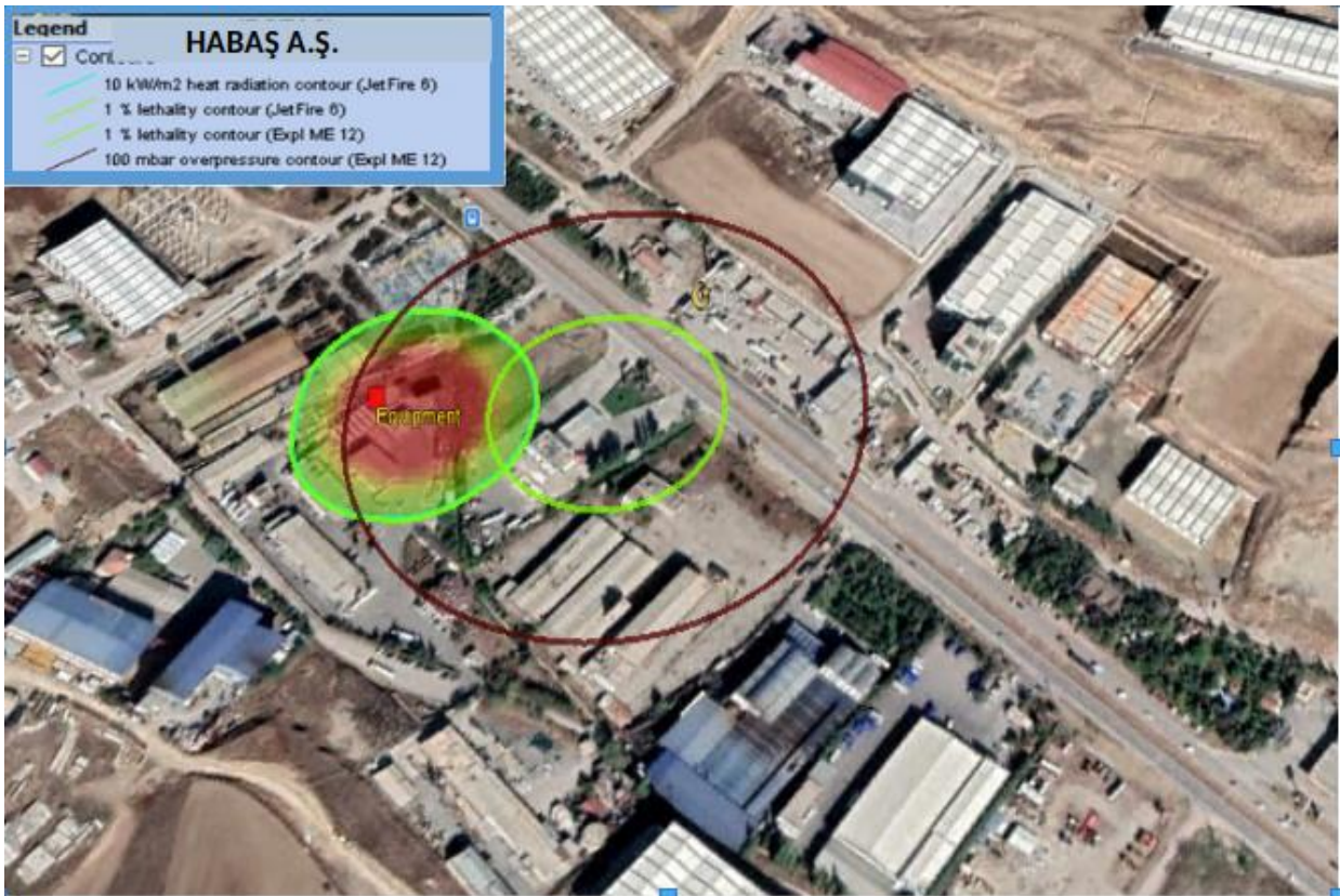
Şekil 2.29. Havaş Sinai ve Tıbbi Gazlar İstihsal End. A.Ş. Ankara Şubesine Ait Tehlike Analizi
